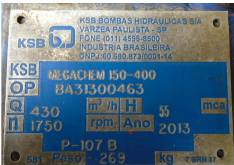
Exemplo de plaqueta de especificações técnicas do equipamento
